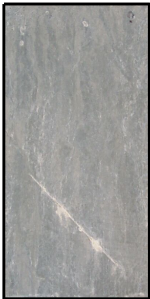
2185 GALVA ZINC 48 µm suh barvni film
